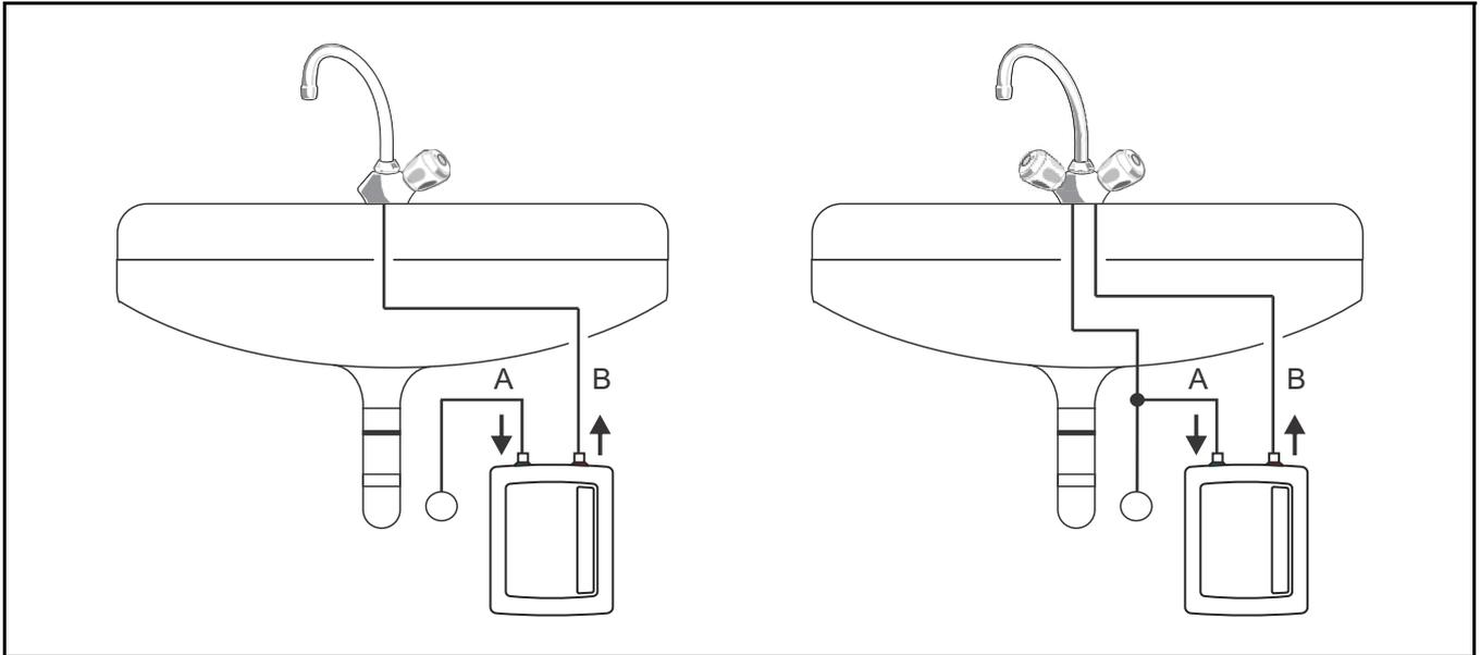
A = Kaltwasserzulauf, B = Warmwasserauslauf
