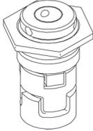
Die Gleitringdichtung wird in das Kopfstück geschraubt.
