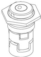
Die Gleitringdichtung wird in das Kopfstück geschraubt.
