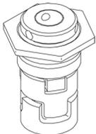
Die Gleitringdichtung wird in das Kopfstück geschraubt.
