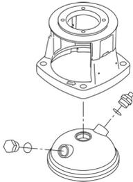
Die Pumpe ist mit einer entlasteten O-Ring-Dichtung mit drehsteifer Drehmomentübertragungseinheit ausgerüstet.
