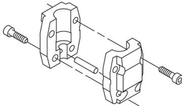
Das Kopfstück und der Flansch für die Motormontage sind ein Bauteil, das aus Grauguss gefertigt wird. Die Abdeckung des Pumpenkopfs ist ein getrenntes Bauteil aus Edelstahl. Das Kopfstück besitzt einen kombinierten Einfüll- und Entlüftungsstopfen (1/2").
