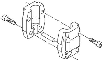
Der Pumpenkopf, die Abdeckung des Pumpenkopfs und der Flansch für die Motormontage werden als ein Bauteil geliefert. Der Pumpenkopf besitzt einen kombinierten Einfüll- und Entlüftungsstopfen (1/2 Zoll).
