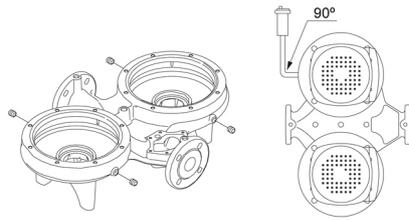
Die Flansche haben Gewindebohrungen für die Montage von Manometern.
